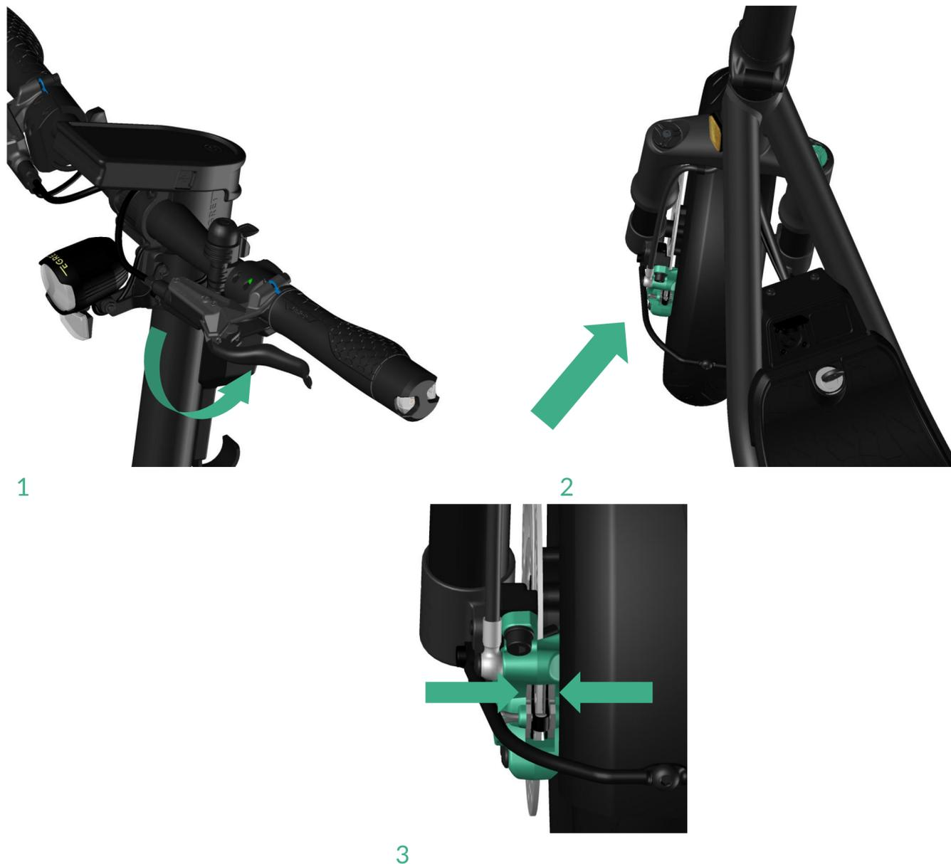
1. Jetzt musst du den Bremssattel noch ausrichten. Ziehe hierfür den linken Bremshebel für die Vorderradbremse fest an (siehe Bild 1). Wenn du dafür den Lenker etwas nach rechts einschlägst (siehe Bild 2), kannst du erkennen, wie sich der Bremssattel bewegt. Wiederhole den Vorgang 1 - 2 Mal.
